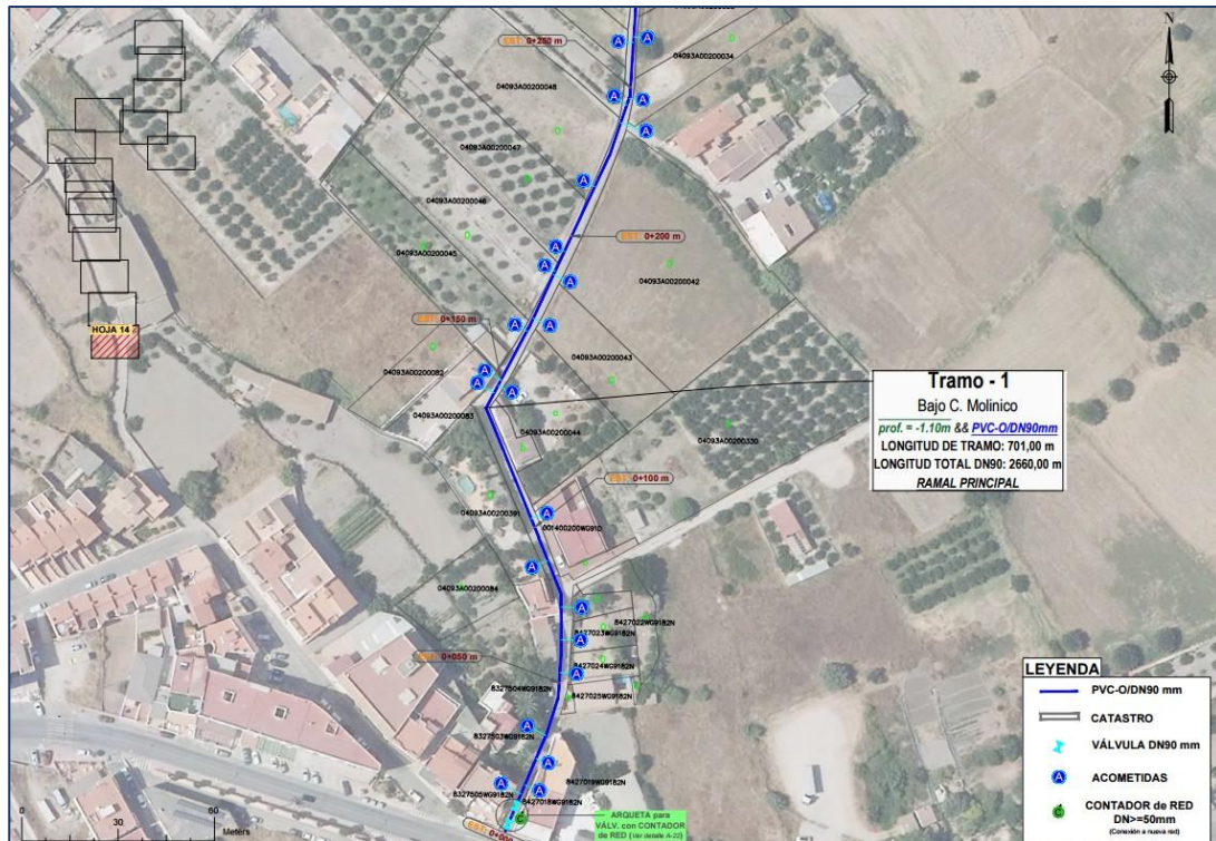
Figura 8: Estado definitivo. Inicio de Tramo 1, Tub. PVC-O DN90mm.
